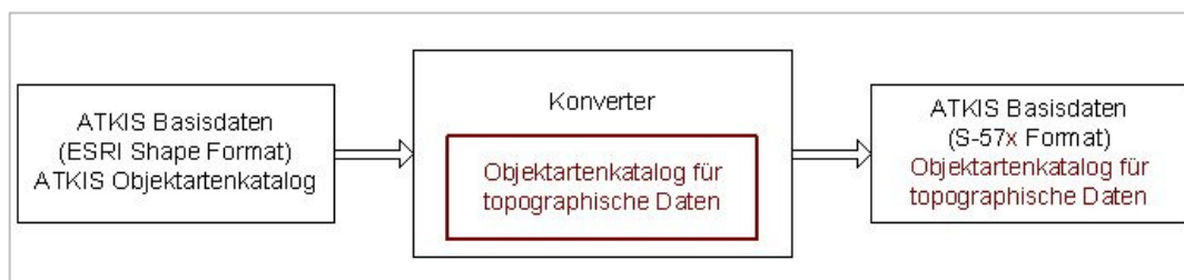
Abbildung 7.4: Konvertierungsprozess ESRI Shape (ATKIS) nach S-57x
