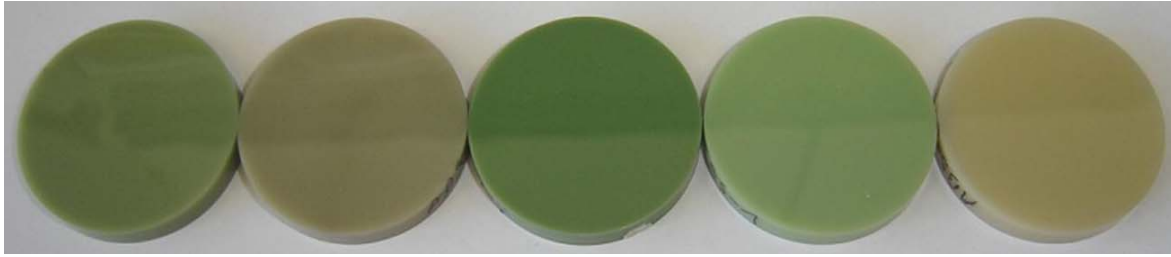
Abbildung 26 Aufnahme von Probenscheiben aus ABS (Dicke: 6 mm)
