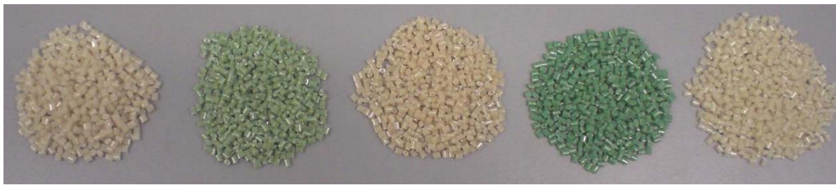
Abbildung 13 Durch Extrusion hergestellte Granulatproben
