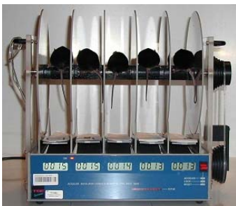
Abb. 3.10: Rotarod Apparatur. Die Mäuse müssen auf einem langsam schneller werdenden Stab laufen, bis sie herunterfallen.
