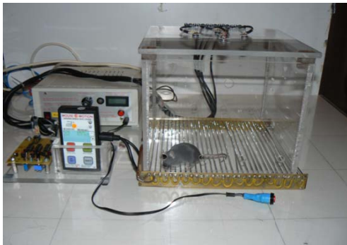
Abb. 3.8: Aufbau der fear conditioning Kammer. Der Deckel der Plexiglasskammer ist mit Infrarotsensoren ausgestattet und über eine Schaltereinheit mit dem MOUSE-E-MOTION® Mikroprozessor verbunden. Der Metallgitter-Boden ist an eine Spannungsquelle gekoppelt, die auf Knopfdruck einen Stromschlag von 250 \mu A erzeugt.
