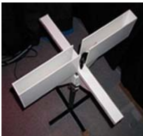
Abb. 3.5: Elevated plus maze . Die Arena besteht aus zwei sich kreuzenden Armen. Zwei Seiten des Kreuzes sind offen, während die zwei anderen von 15 cm hohen Wänden begrenzt sind.
