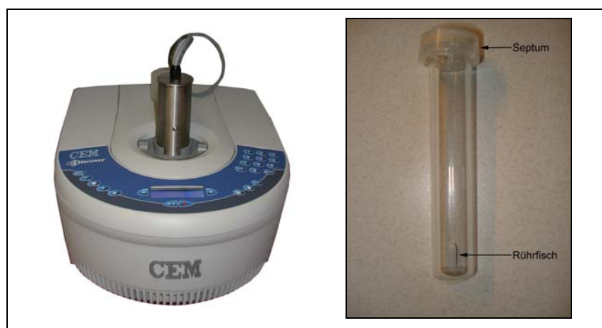
Abb. 1.23: Synthesemikrowelle Discover™ und ein 10 mL Druckvial aus Quarzglas der Firma CEM, Kamp-Lintfort, Deutschland
