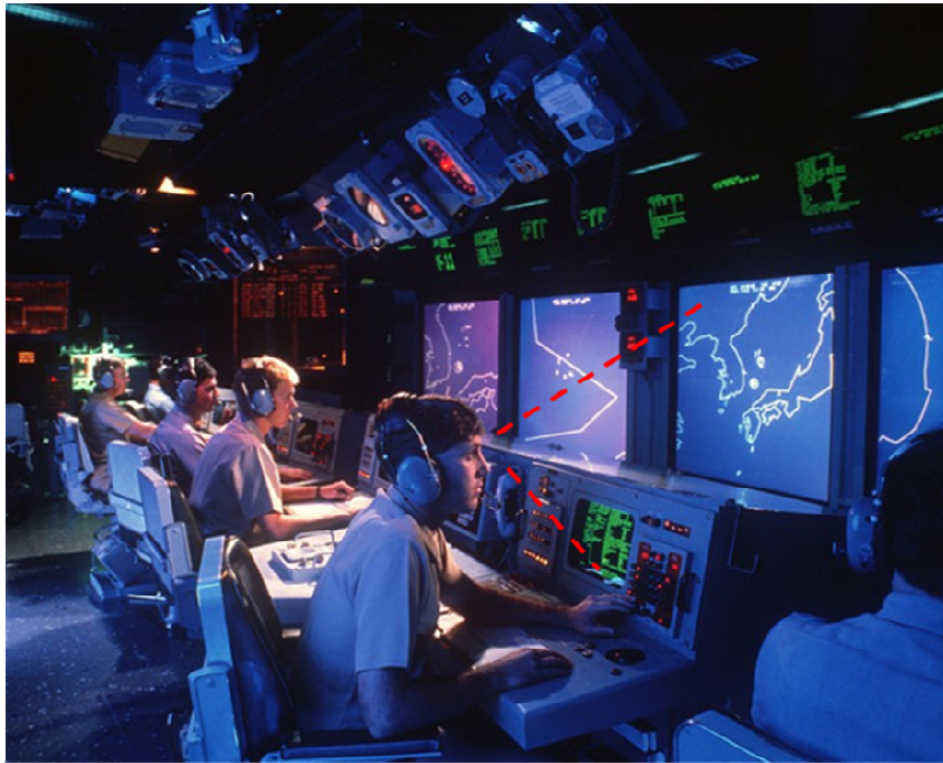
Abbildung 2. Bildschirmarbeitsplatz in der Kommandozentrale der Vincennes, Photographie der US Navy, Blickrichtungen des Bediener hinzugefügt
