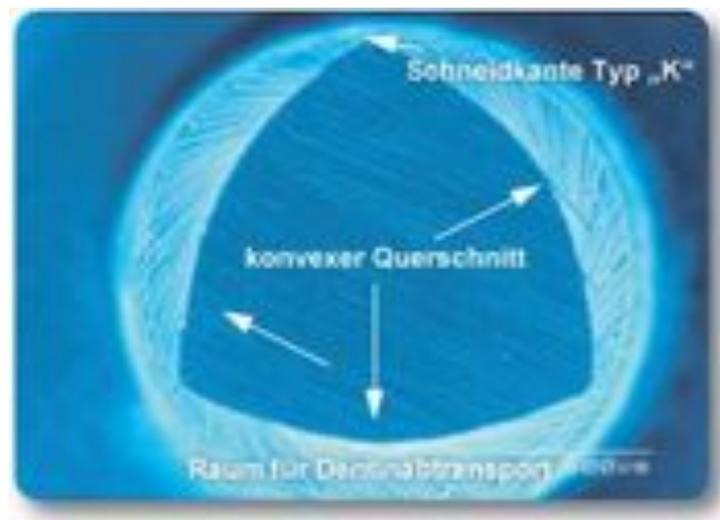
Abb. 34: Querschnitt einer FlexMaster-Feile als rasterelektronenmikroskopische Aufnahme mit 500-facher Vergrößerung (Herstellerfoto 2008)
