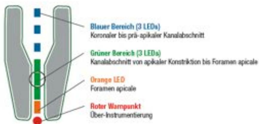
Abb. 31: Darstellung der Feilenspitzenposition beim VDW.Gold (Betriebsanleitung 2008)
