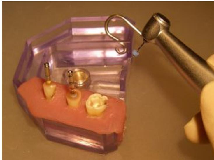
Abb. 50: Versuchsaufbau für die Aufbereitung bei gleichzeitiger endometrischer Messung. Die zwei einwurzligen Zähne sind bereits aufbereitet und die Feilen mit Klebewachs fixiert.
