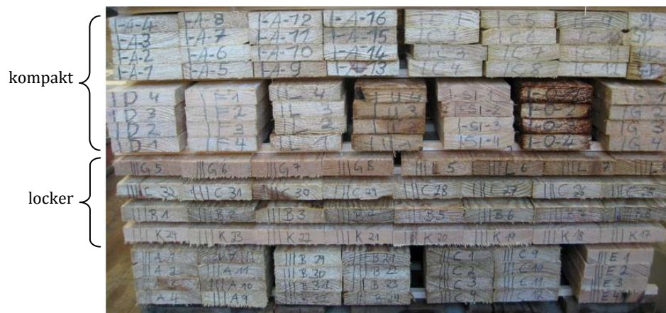
Abbildung 9: Versuchsstapelaufbau Innenlagerung Laborserie (Format A n ).
