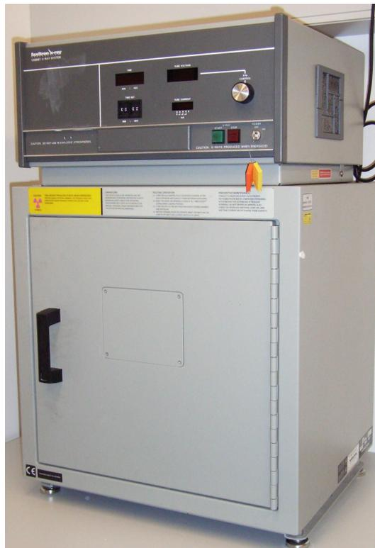
**Abbildung 15:** Röntgenkammer für die Anfertigung der Kontaktradiographien
