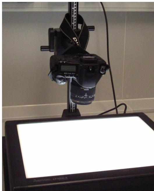
**Abbildung 13:** Kamera mit Stativ und Durchlichteinrichtung
