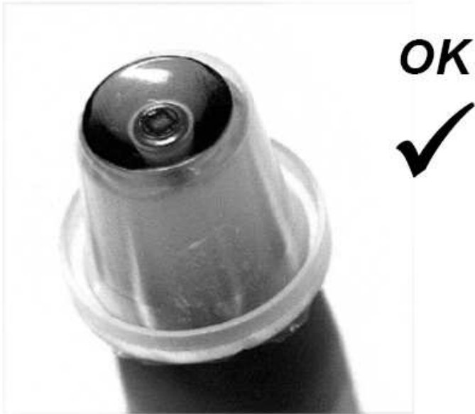
Abb. 10: Sensor-Tip mit aufgesetztem Sensor Cap ( korrekter Sitz ):
