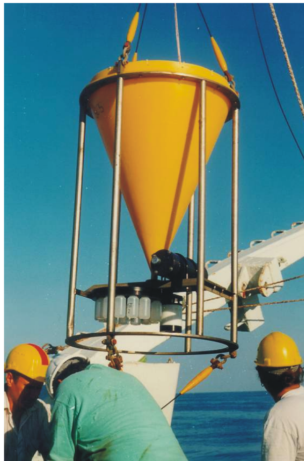
Abb.10: Sedimentfalle des im Südchinesischen Meer eingesetzten Typs „Mark VI“, McLane Research (Foto: S. Reschke).
