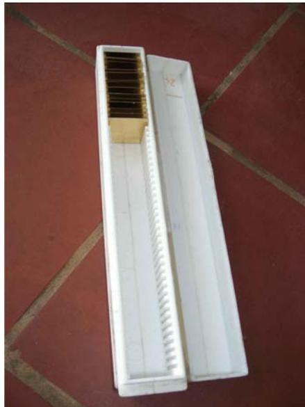
**Abb. 127: Goldsubstrate in der angefertigten Aufbewahrungs- und Transportbox.**
