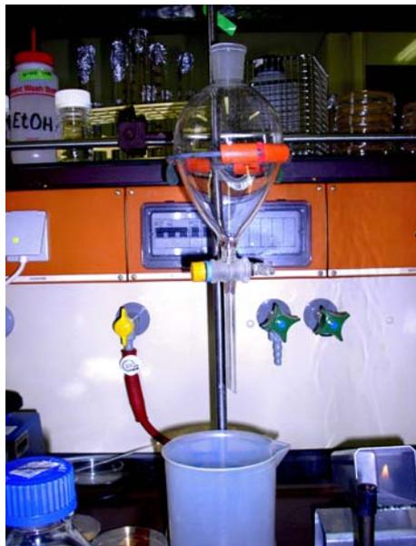
**Abb. 32: Spülvorrichtung zum Spülen der Proben nach der Adhäsion.**
