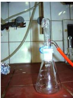
**Abb. 129: Zerstäuber zum Besprühen von Stahl- und Aluminiumsubstraten.**
