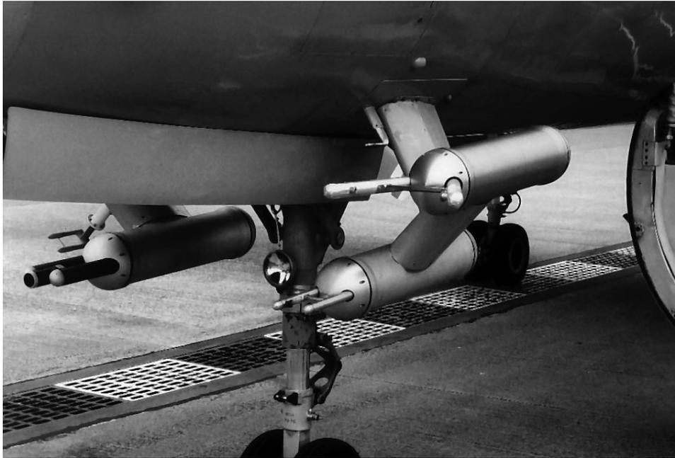
Abb. 3.5: Montierte Sonden am Flugzeugrumpf. Links FSSP, rechts unten 2D-C und rechts oben 2D-P.
