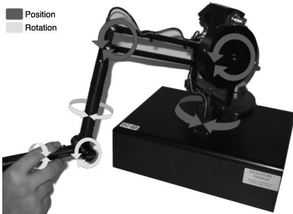
**Abbildung 3.10:** Force-Feedback-Eingabegerät der Firma *Sensable*<sup>®</sup> mit 6 Freiheitsgraden. Die maximal simulierbare Kraft beträgt 37,5 N, die kontinuierlich ausgebare Kraft 6,2 Newton [28, 29, 30].
