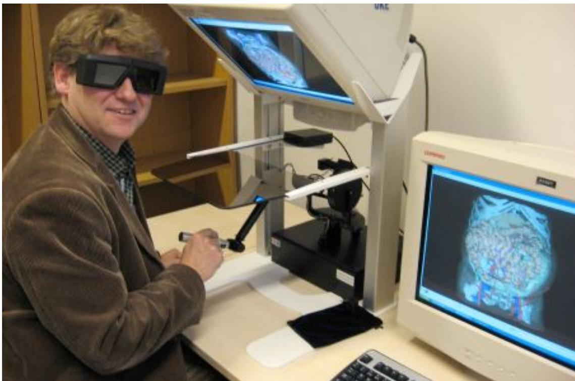
**Abbildung 3.11:** Das Punktionssetting. Prof. Handels mit Shutter-Brille (vgl. Fußnote auf S. 62) am haptischen Eingabegerät. Das 3D-Bild wird auf den Spiegel über dem Eingabegerät projiziert und so ein größerer Realismusgrad erzielt [43, S.389]. Rechts befindet sich der Arbeitsplatz des Betreuers des Punktionsstrainings.
