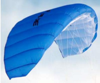
In den 90ern entstand ein alternatives System zu den Tubekites, die Mattenkites (Ram-Air-Kites). Der Begriff Ram-Air bezieht sich auf die getaute Luft zwischen Ober- und Untersegel, wodurch die Form des Kite bedingt wird. Die Mattenkites ähneln vom Prinzip her den
