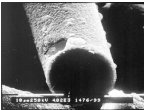
Abbildung 21: REM-Aufnahme einer beschichteten Quarzfaseroberfläche; Abscheidungsbedingungen 360°C, 7h (links) und zugehöriges EDX-Spektrum (rechts)
