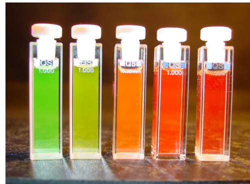
Abb. 1.1 – Die Photolumineszenz mit HF geätzter InP-Nanokristalle unterschiedlicher Teilchengröße
