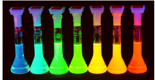
Abb. 3.1 – Stark lumineszierende CdSe/ZnS-Kern-Schale-Nanokristalle unterschiedlicher Größe
