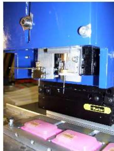
Abbildung 3: TMA-Herstellung. Das Gewebearray-Stanzgerät (unten) ist ein Präzisionsgerät, in dem ein an der Spitze geschärfter Hohlzylinder (innerer Durchmesser 0,6 mm) und einen 0,6 mm durchmessender Bohrer gehalten werden. Zunächst wird für jede Stanze in einen Empfängerblock ein Kanal gebohrt (a). Dann wird das zu entnehmende Areal auf einem HE-Schnitt genau lokalisiert (b,c). Aus dem jeweiligen Spenderblock („donor“) wird die markierte Gewebeprobe entnommen (d). Die entnommene Stanze wird nun in den Empfängerblock eingebracht (e), beim Ausstoßen hilft ein im Hohlzylinder befindlicher Stahldraht. Ein verstellbarer Eindring- Stopper garantiert eine konstante Länge von Gewebeproben und vorgefertigten Löchern.
