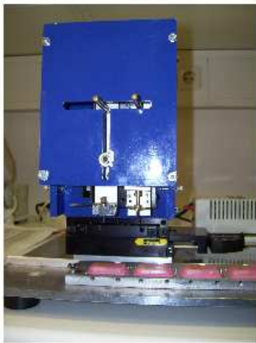
Abbildung 3: TMA-Herstellung. Das Gewebearray-Stanzgerät (unten) ist ein Präzisionsgerät, in dem ein an der Spitze geschärfter Hohlzylinder (innerer Durchmesser 0,6 mm) und einen 0,6 mm durchmessender Bohrer gehalten werden. Zunächst wird für jede Stanze in einen Empfängerblock ein Kanal gebohrt (a). Dann wird das zu entnehmende Areal auf einem HE-Schnitt genau lokalisiert (b,c). Aus dem jeweiligen Spenderblock („donor“) wird die markierte Gewebeprobe entnommen (d). Die entnommene Stanze wird nun in den Empfängerblock eingebracht (e), beim Ausstoßen hilft ein im Hohlzylinder befindlicher Stahldraht. Ein verstellbarer Eindring- Stopper garantiert eine konstante Länge von Gewebeproben und vorgefertigten Löchern.
