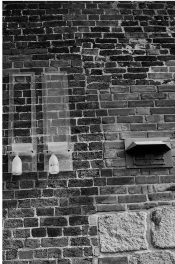
**Abb. 5-16:** Anbringung der Ablaufwassersammler an der St. Laurentii-Kirche in Süderende; Regendach für Ziegel-Plättchen zur Untersuchung der trockenen Deposition
