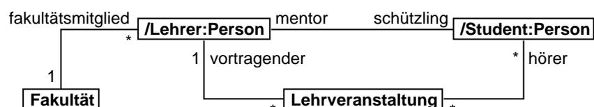
Abbildung 2.12: Eine UML-Kollaboration auf Spezifikationsebene aus [Hitz und Kappel 1999], S. 125.
