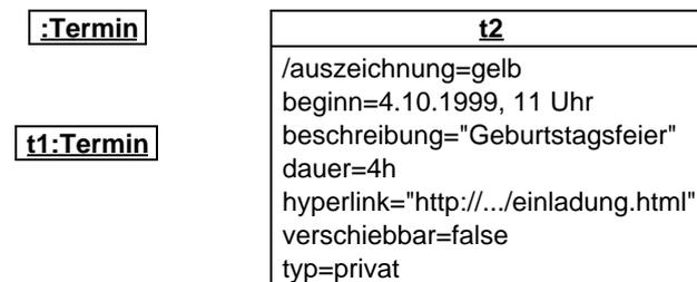
Abbildung 2.8: Darstellung von Objekten in UML-Notation.
