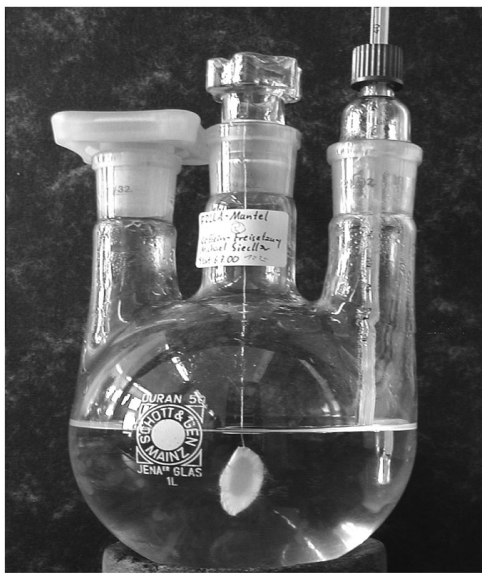
Abbildung D.17: Aufnahme des Versuchsaufbaus zur Ermittlung der Freisetzungskinetik von Coffein.
