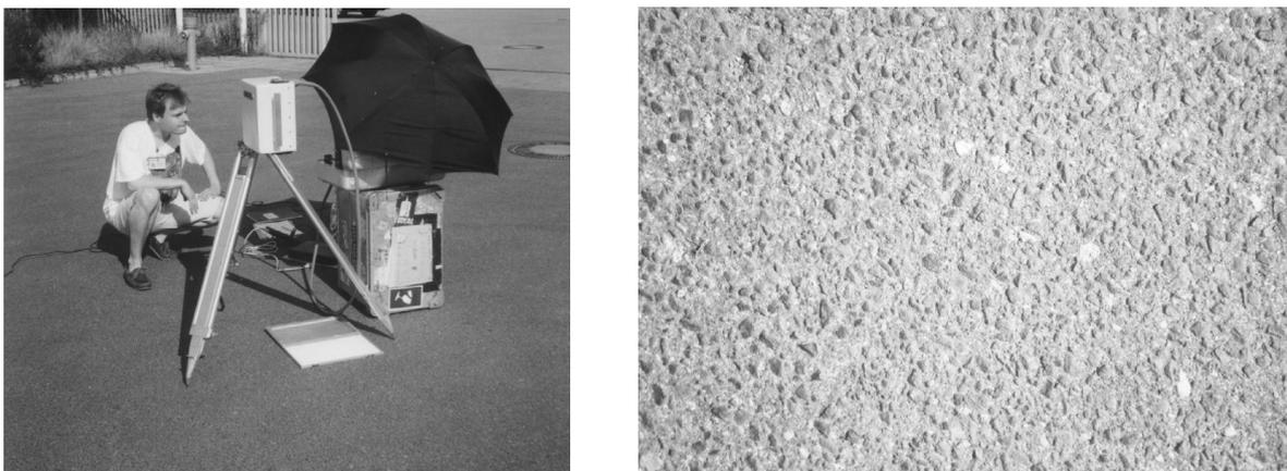
Abbildung 3.13: Meßort 5: Asphalt Gewerbegebiet. Übersicht (linke Abbildung) und Nahaufnahme (rechte Abbildung) der Asphaltfläche im Gewerbegebiet 'Andernacher Straße', Nürnberg. In der Bildmitte der linken Grafik sieht man das IRIS-Spektrometer mit Stromversorgung sowie die auf dem Asphalt liegende  $\text{BaSO}_4$ -Referenzfläche.
