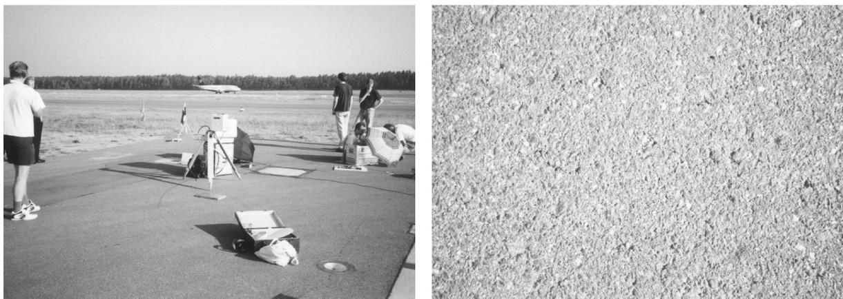
Abbildung 3.10: Meßort 2: Asphalt Flughafen. Die linke Abbildung zeigt einen Teil der Asphaltfläche am Flughafen Nürnberg, die rechte Grafik eine Nahaufnahme der Oberfläche. Am linken Bildrand der rechten Grafik sieht man Mitglieder unserer Arbeitsgruppe bei der Vorbereitung von BRDF-Messungen von Asphalt [MWM<sup>+</sup>98, Mon98].
