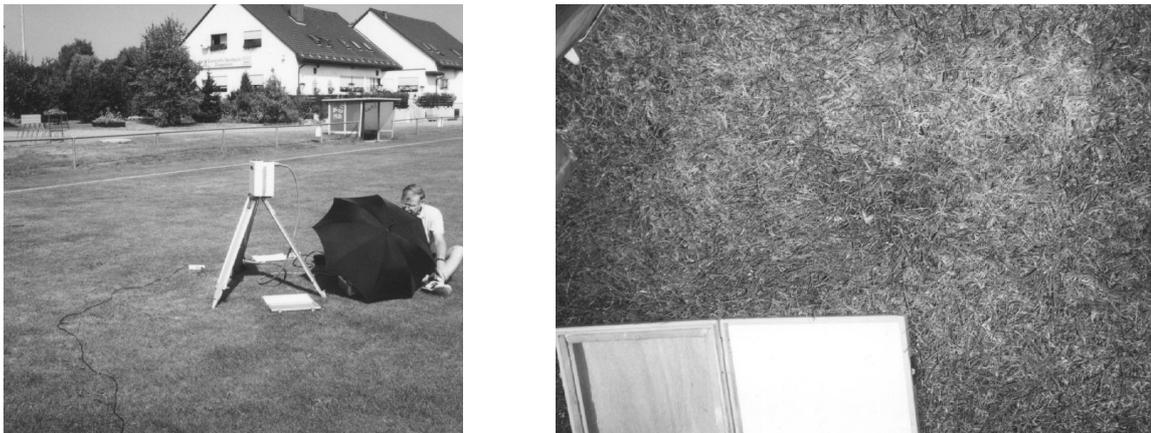
Abbildung 3.14: Meßort 6: Naturrasen. Übersicht (linke Abbildung) und Nahaufnahme (rechte Abbildung) der Naturrasenfläche. Aufgrund der starken Inhomogenitäten wurde an verschiedenen Stellen der Rasenfläche ein Spektrum gemessen.
