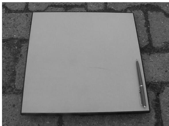
Abbildung 4.3: Photo der Probe 'Spectralon'.
