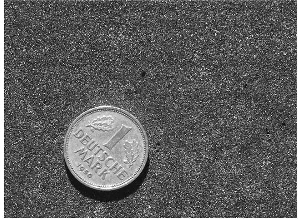
Abbildung 4.8: Photo der Probe 'Bestreute Dachpappe', Vergrößerung
