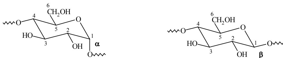
Abbildung 2-2 Monomerbaustein von Poly-(D-Glucopyranose), die zwei möglichen 1,4-Verknüpfungen \alpha und \beta sind hier angedeutet.
