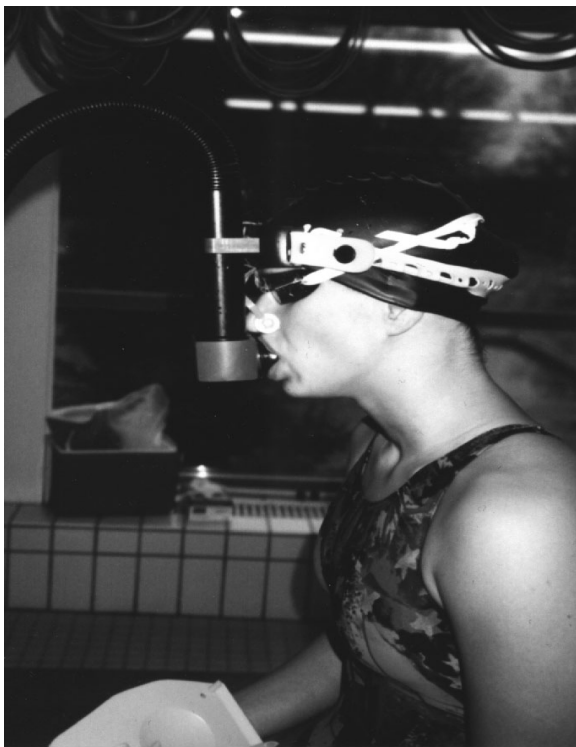
Abb. 6: Schlauchsystem der Ventil-Mundstückmaske
