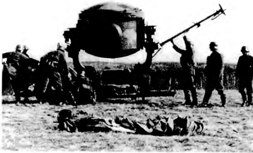
335 Aufstellung und waagerechte Ausrichtung eines Flakscheinwerfers (Müller 1984, S. 122)
