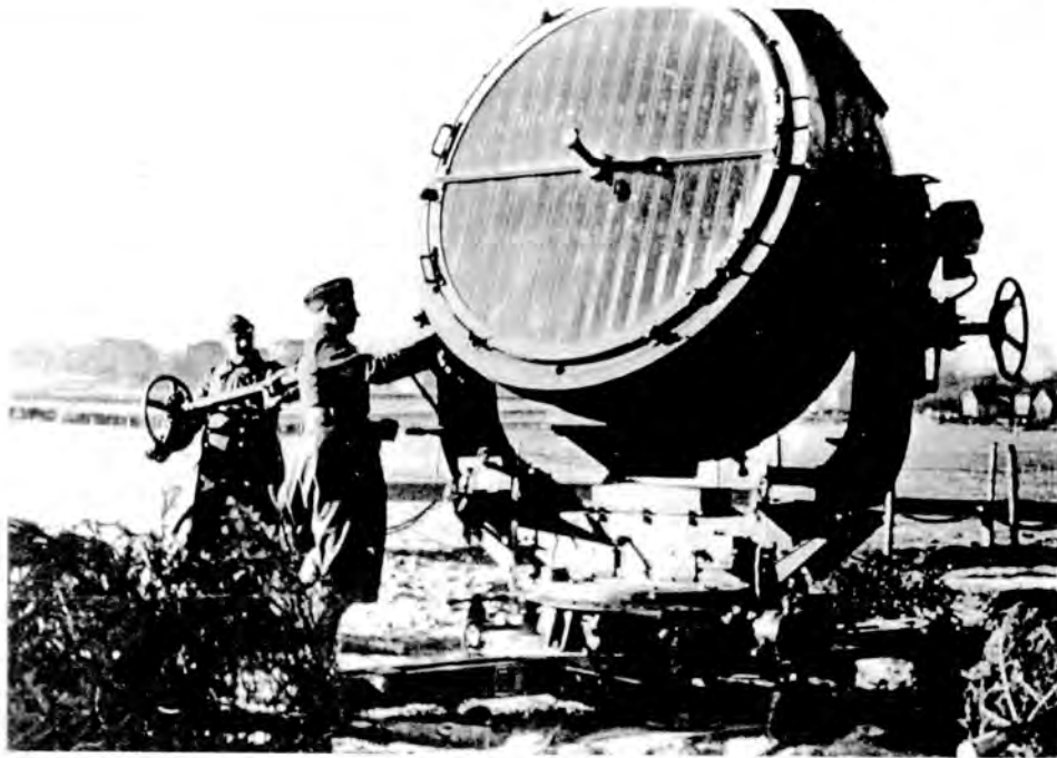
332 Ein 150cm-Flakscheinwerfer wird "in Stellung" gebracht. Die Blende des Scheinwerfers ist noch geschlossen (Müller 1984, S. 121)
