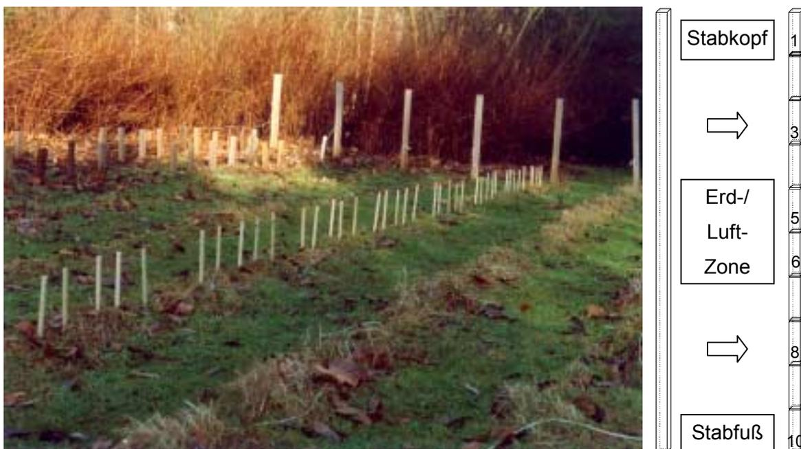
Abbildung 60: Freilandtestfeld des Instituts mit Kupfer-HDO-haltigen Proben im Erdkontakt sowie schematische Darstellung der Segmentierung für die Bestimmung von Wirkstoffgehalten
