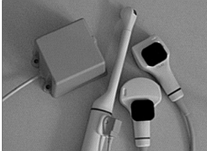
Abbildung 4.5: Tracking-System der Firma '3D-Echotec'. Der Quader links im Bild ist der Magnetfelderzeuger. In der Mitte ist ein länglicher Schallkopf dargestellt, der z.B. bei gynäkologischen Untersuchungen angewandt wird. An dessem Stil aufgesetzt erkennt man einen kleinen Magnetfeld-Sensor. Rechts nebendran sind noch zwei weitere, etwas größere Magnetfeld-Sensoren abgebildet.
