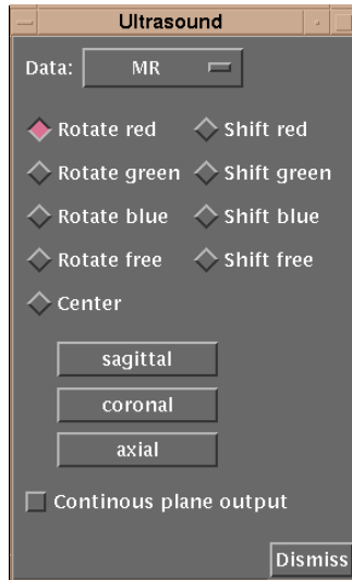
Abbildung 3.8: 'Ultrasound'-Menu mit mehreren Einstellmöglichkeiten zur Auswahl der Drehachsen und der Koordinaten des Aufsetzpunktes für die interaktive Bewegung des Schallkopfmodells.
