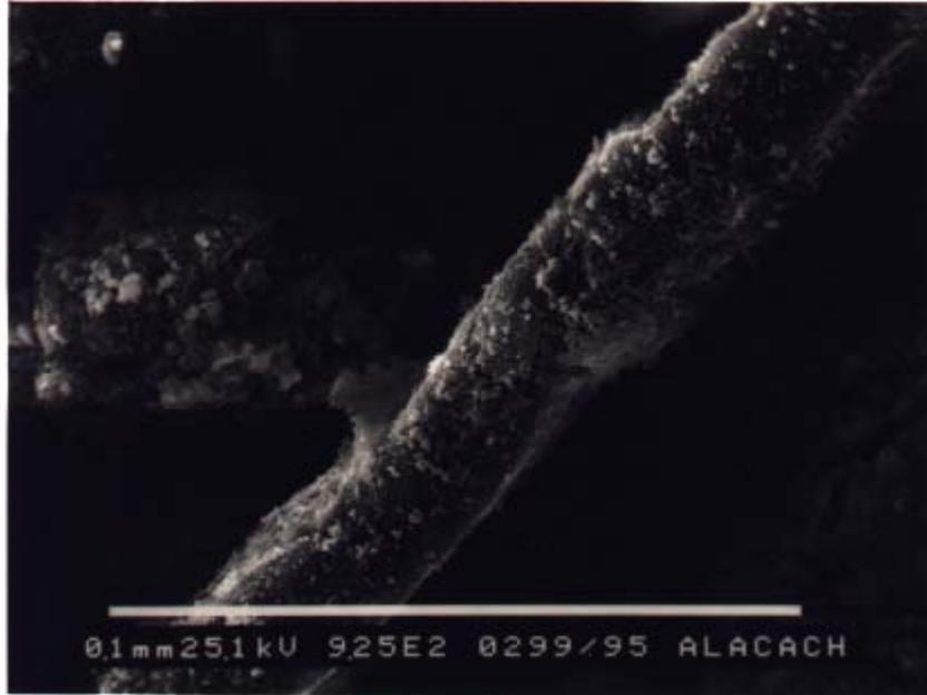
**Abb. D20:** REM-Aufnahme des Zersetzungsprodukts nach 30 min (x 925)
