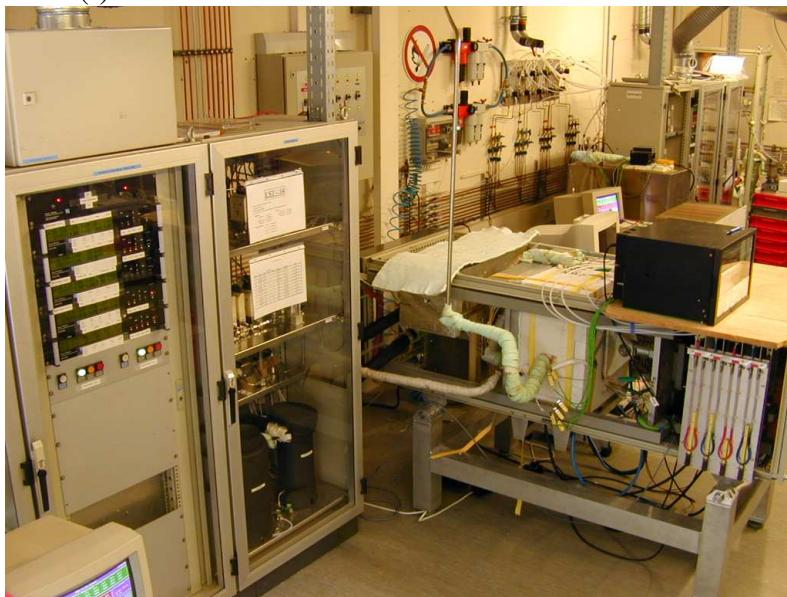
Abb. 3.1 MCFC-Teststand
