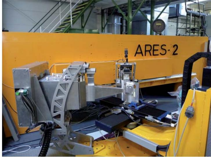
Abbildung 3.15: Der Meßplatz ARES-2 am Forschungsreaktor Geesthacht. In der Mitte das Schwerlastdiffraktometer mit dem Probenort
