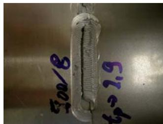
Abbildung 4.30: Bild der Aluminium-Stahl-Verbindung, die aus dem in-situ Versuch entstanden ist. Auf der linken Seite befindet sich das Aluminium, auf der rechten Seite ist der Stahl.
