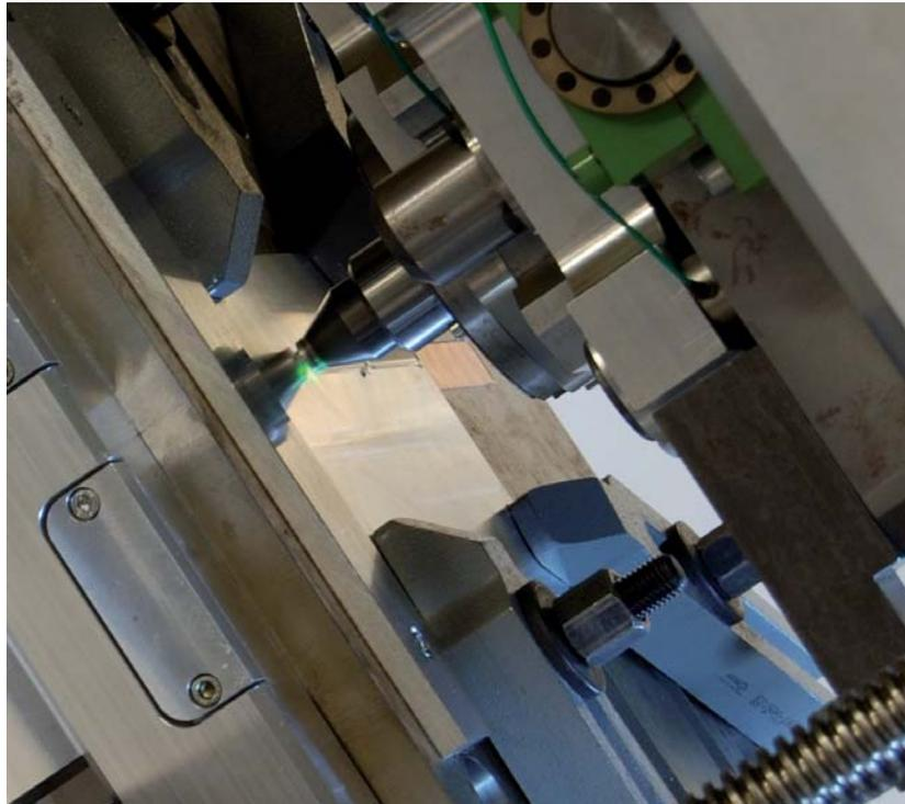
Abbildung 3.7: Blick auf den Probenort der *FlexiStir*. Das Werkzeug setzt auf das Aluminiumblech auf und der grüne Laserpunkt deutet die Meßposition in der Wärmeeinflußzone seitlich zum Werkzeug an.
