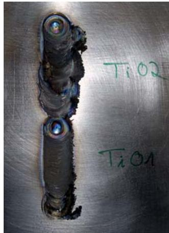
Abbildung 4.34: Schweißprobe der in-situ Versuche mit Ti-6Al-4V
