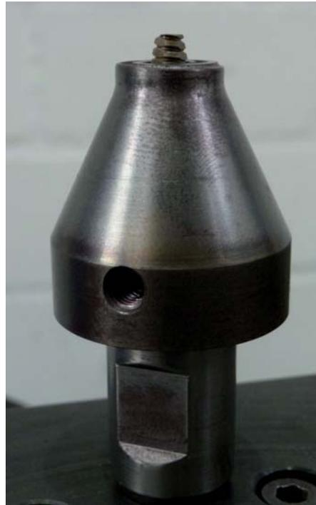
Abbildung 2.2: Foto des verwendeten Werkzeugs; der schmale Stift sitzt mittig auf der Werkzeugschulter.
