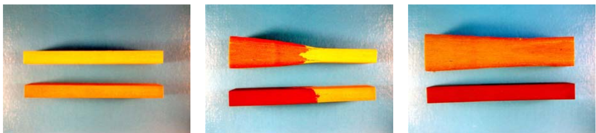
Abbildung 49 Dickenquellung bindemittelfreier MDF aus 8 bar-Faserstoff (jeweils oben) sowie MDF aus 16 bar-Faserstoff (jeweils unten) nach 30 min (mittiges Bild) sowie nach 24 h (rechtes Bild) zu einem Drittel in Wasser gelagert im Vergleich zur Ausgangsprobe vor Wasserlagerung (linkes Bild), Fotos Stephani (IHD)
