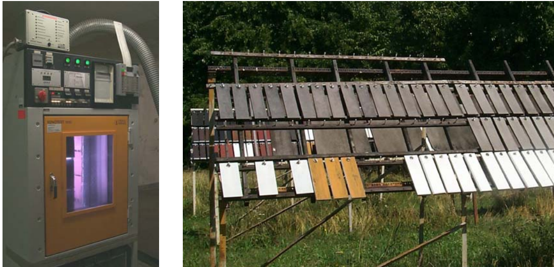
Abbildung 30 Kurzzeitbewitterungsbeanspruchung (KZB, auch Short-term Technical Weathering = TW) im Xenotest-Gerät 1200 (links, Foto Stephani, IHD) sowie IHD-Versuchsstand zur Freilandbewitterung (FB, auch Outdoor Exposure = OE) nach DIN EN 152 (rechts, Foto Stephani, IHD)
