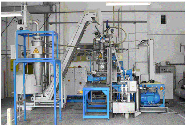
Abbildung 28 links: Laborrefineranlage des IHD Dresden /Stephani 2006/; rechts: Anlagenlayout/Flowsheet der IHD-Laborrefineranlage (Bild Andritz AG) einschließlich Leistungsangaben
