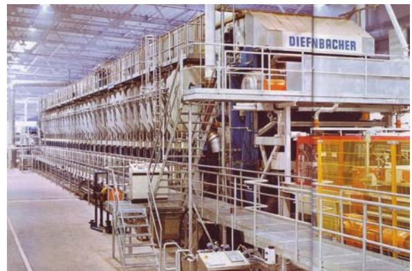
Abbildung 22 links: weltweit erst kontinuierliche Holzwerkstoffpresse 1974 (für Spanplatten) bei Kunz Gschwend (Küsters/Metso) /Bluthardt, Mohr 2000/, rechts: kontinuierliche Dünn-MDF-Anlage (Dieffenbacher) /N. N. 2006d/
