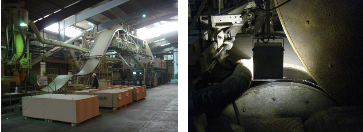
Abbildung 23 Kalanderpresse für Dünn-MDF, Masisa, Mapal (Chile) links: Gesamtansicht, rechts: Einlaufbereich /Tobisch 2007/
