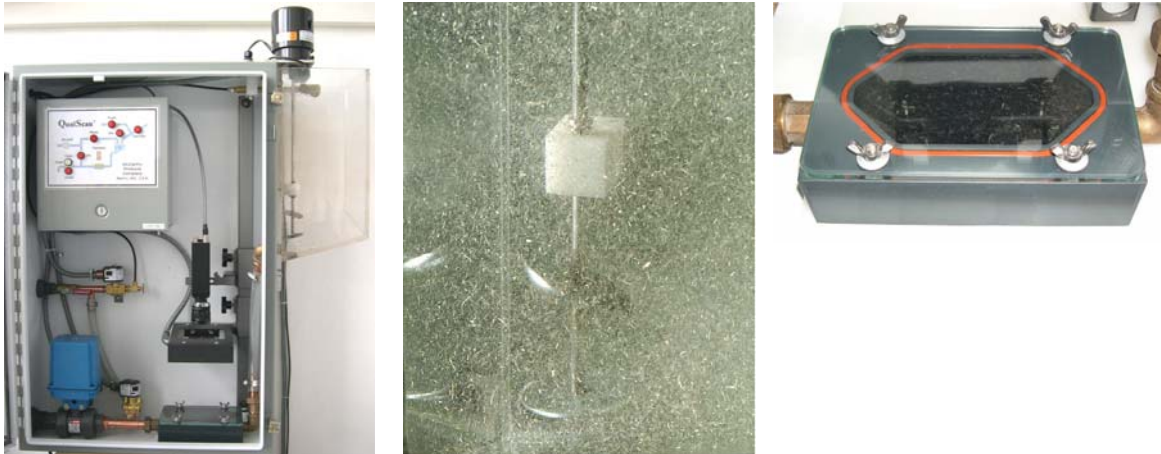
Abbildung 29 QualScan-System (McCarthy) zur optischen Partikelanalyse, links: Gesamtansicht, mittig: Mischung der Suspension im Mix-Tank, rechts: Flow Cell (Fotos IHD)
