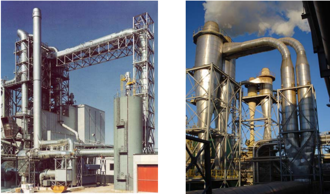
Abbildung 19 Stromrohrtrockner Büttner (links), Zweistufen-Stromtrockner (rechts) Masisa, Concordia (Argentinien) /N.N. 1996; Tobisch 2007/
