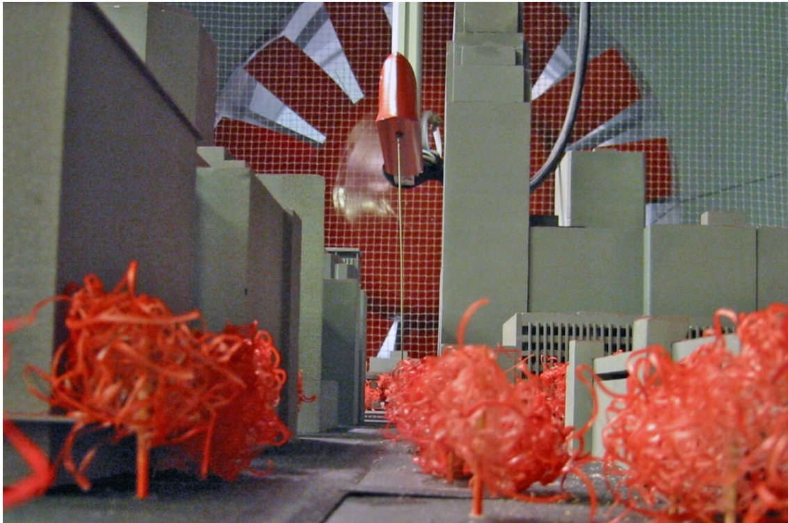
Abbildung 11: Blick entlang der Robinson Avenue im Windkanal Modell von Oklahoma City mit einem an der Traverse montierten Fast-FID.
