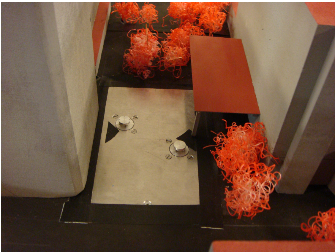
Abbildung 6: Zwei in das Modell eingebaute Emissionsquellen in der Nähe des Westin Hotels.
