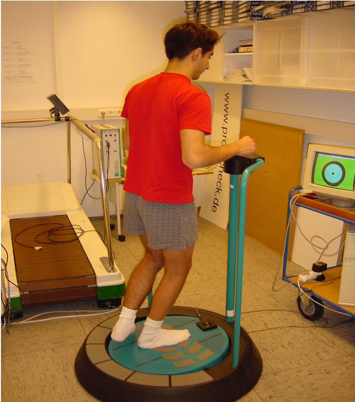
Abbildung 11: KAT 2000, mit im Vordergrund zu sehender Messeinheit und optischer Darstellung der Zielführung für den Probanden auf einem angeschlossenen Computer.
