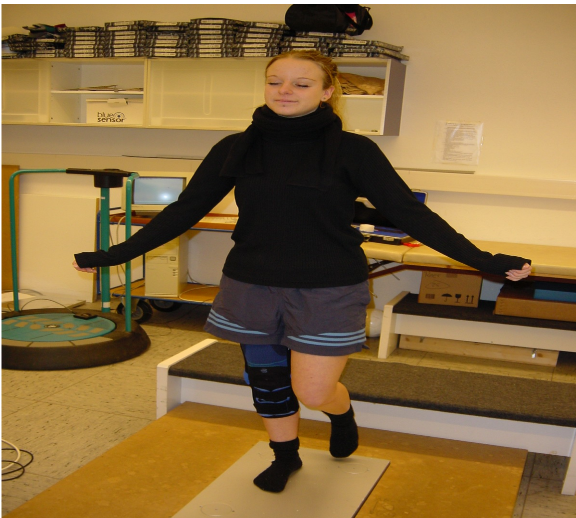
Abbildung 8: Blindtest, Kistlerplatte Patientin mit zur Verblindung geschlossenen Augen
