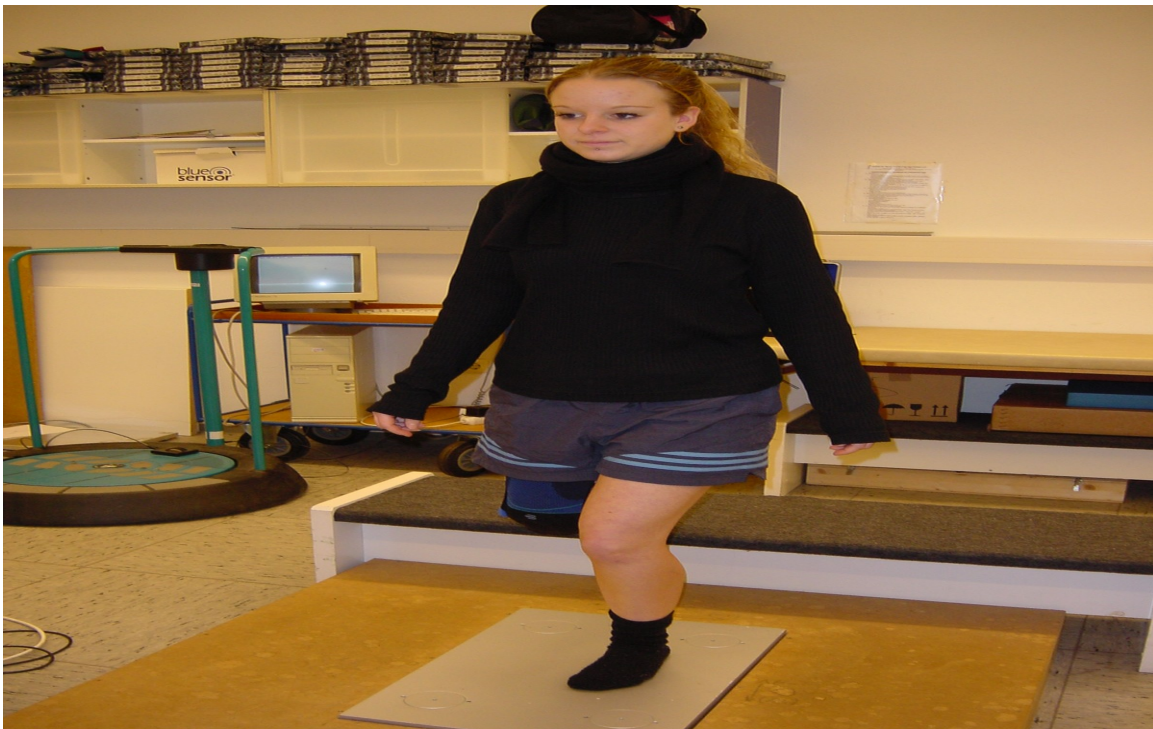
Abbildung 9: Gehstest, Kistlerplatte, Probandin hat mit Gehbein die Kistlerplatte betreten, danach Lösen des Standbeines und Verlassen der Platte
