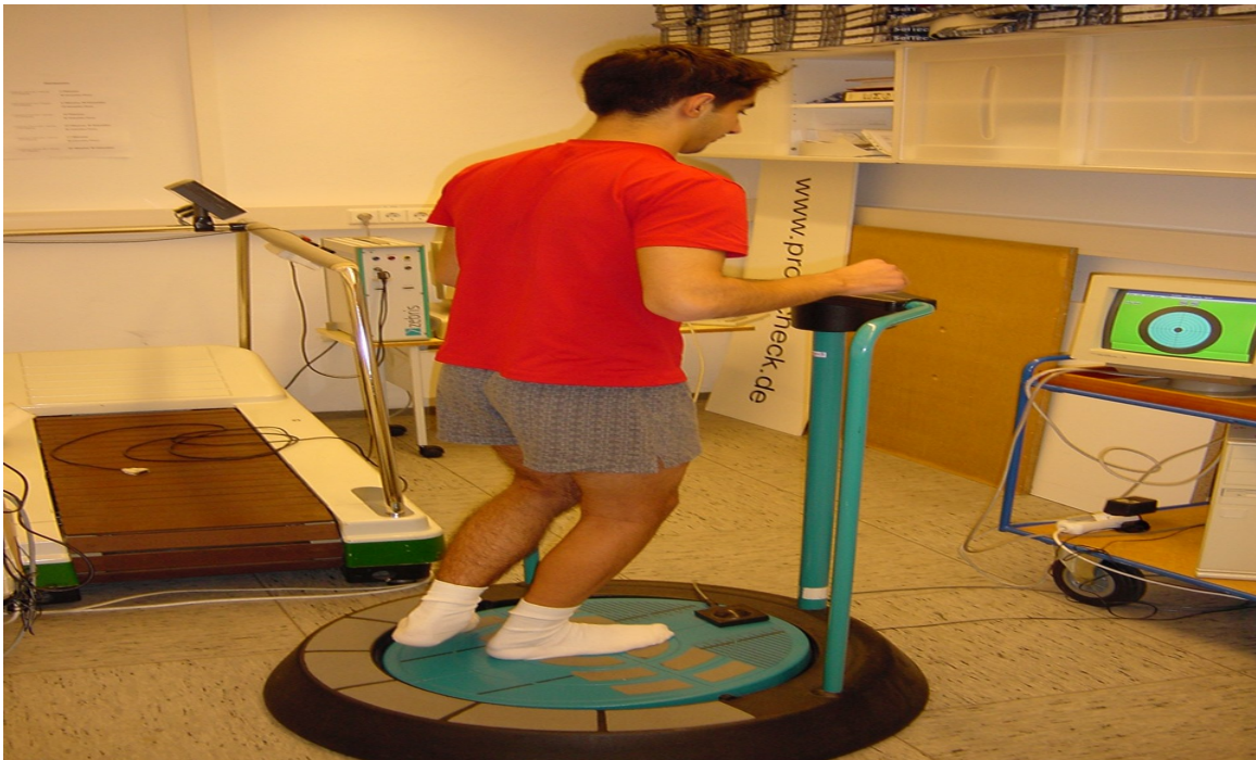
Abbildung 4: KAT 2000, Proband auf KAT 2000, davor in vorgegebenem Abstand Computer mit Zielführung, angeschlossene Messeinheit.
