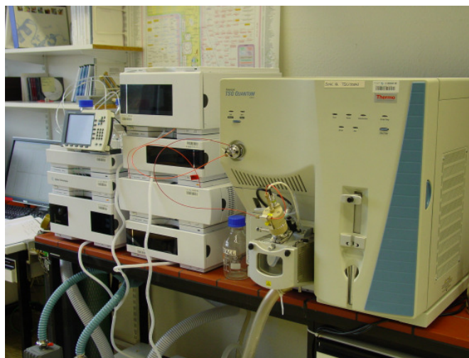
Abbildung 4.6: Agilent 1200 HPLC und TSQ Quantum Ultra™ (Thermo Electron Corporation)
