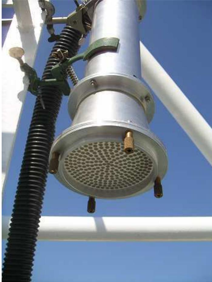
**Abb. 47:** Kollektor mit Filterpapier nach der Durchführung einer Messung
