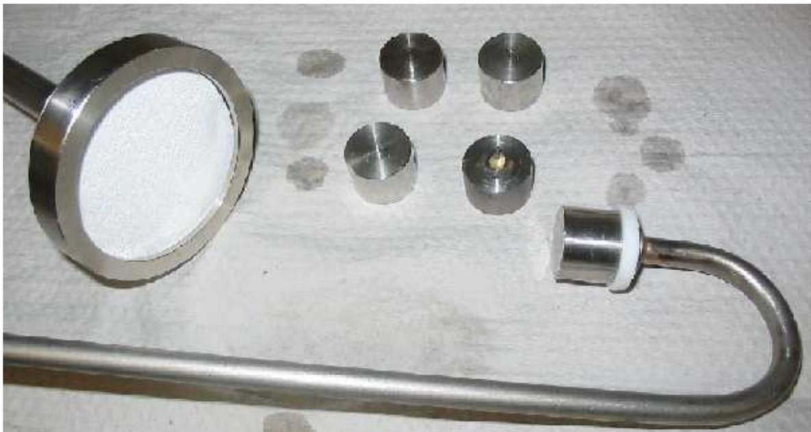
**Abb. 19:** Kollektor und Gaseinleitungsröhre mit verschiedenen Düsenköpfen
