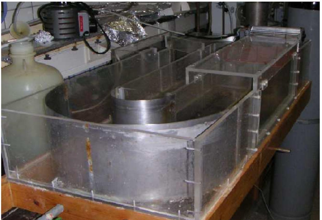
**Abb. 16:** Wellenkanal
