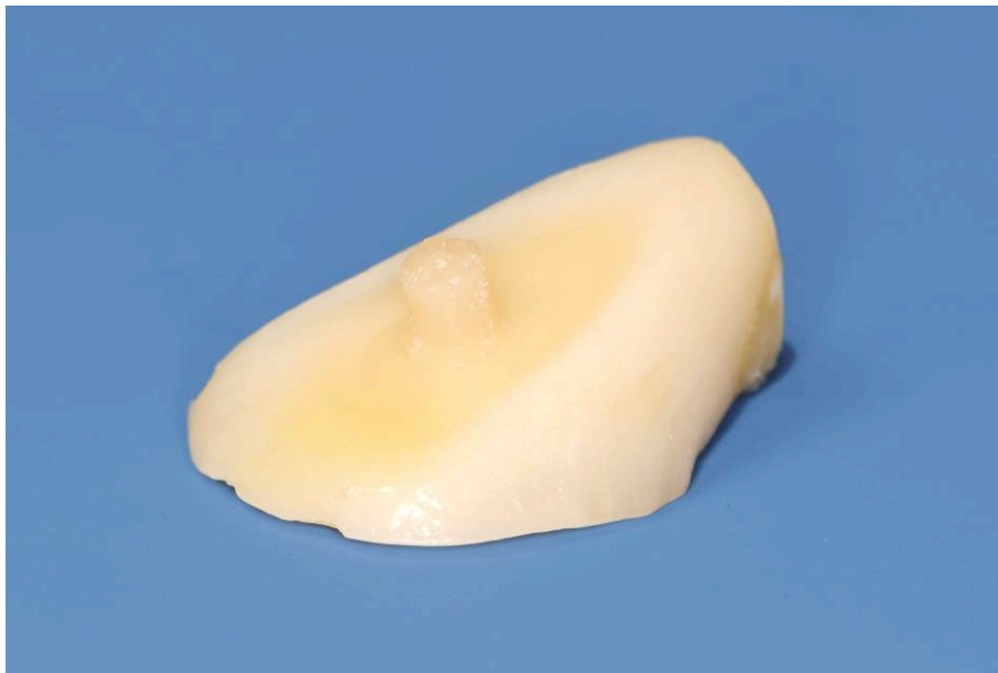
Abbildung 6 Auf Rinderdentin aufgebrachter Kompositzylinder
