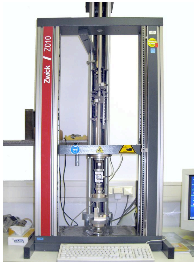
Abbildung 9 Universaltestmaschine Zwick Z010 mit Einspannvorrichtung
