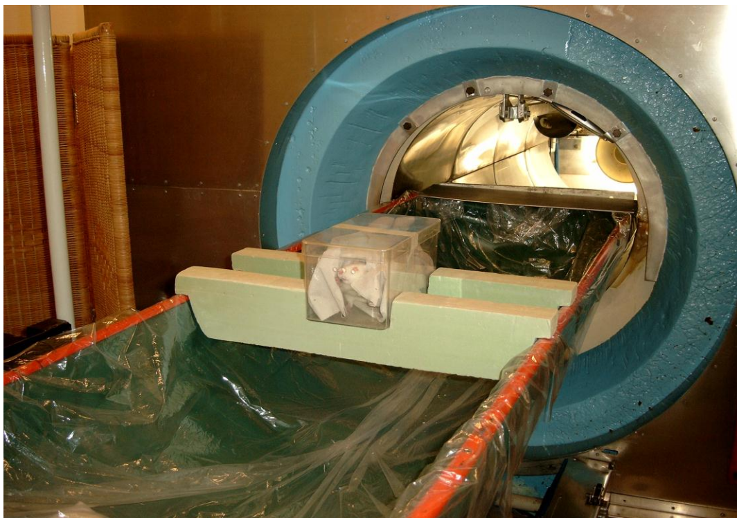
Abbildung 9 Ganzkörperzähler offen mit Ratte in Käfig auf Styroporbrücke
