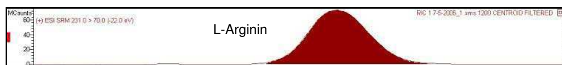
Abbildung 3.9: LC-tandem-MS-Chromatogramm für L-Arginin. Mit Hilfe des Programms „Mass Spectrometry Work Station“ wurde die Fläche unterhalb des Peaks der Kurve bestimmt.
