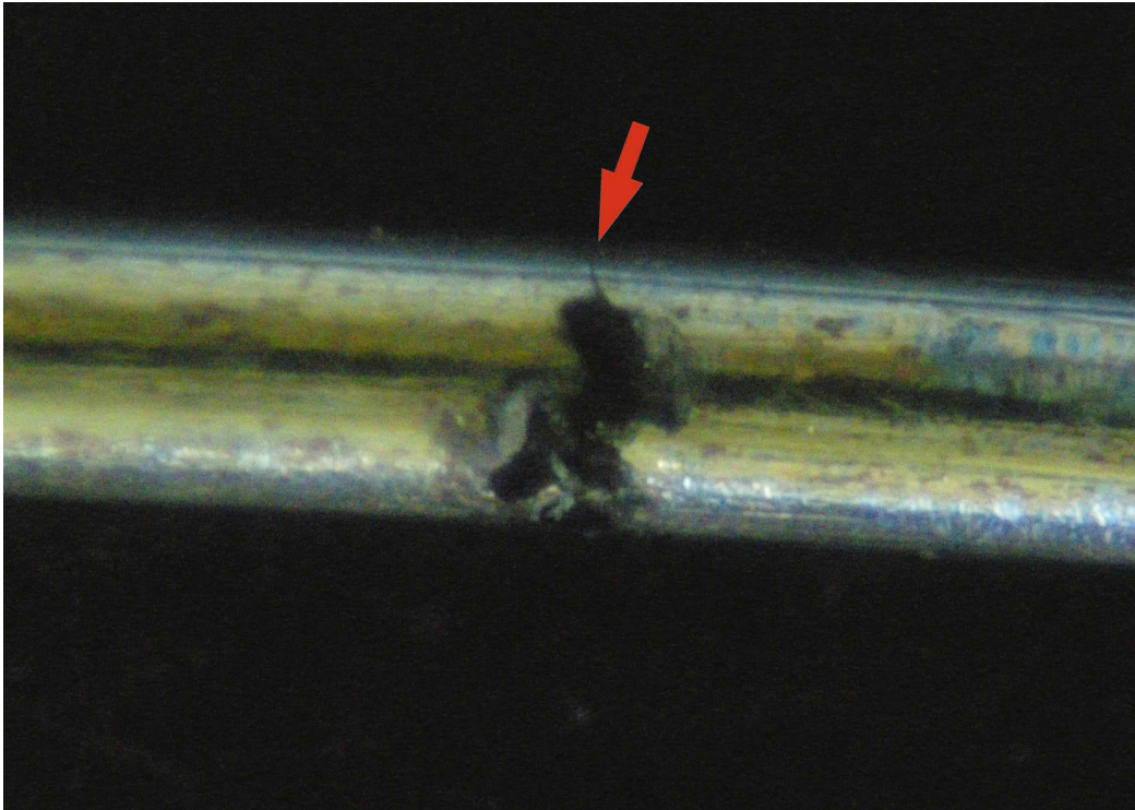
Abb. 20: großer Defekt mit Bruchlinie, ca. 70-fach vergrößert. (Explantat 343)
