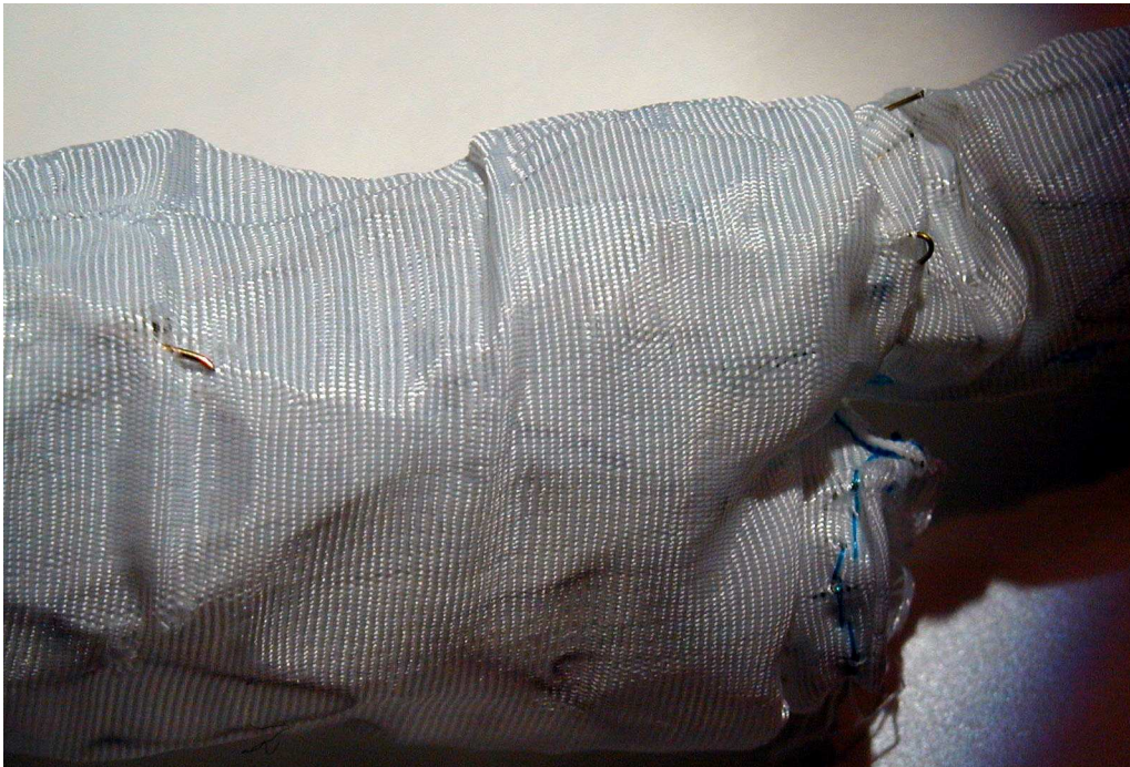
Abb.13: Durchspießungen an Hauptkörper und Ansatzbereich des rechten Beinchens durch Drahtbrüche sowie Durchspießung mit Drahtbogen (Explantat 362)
