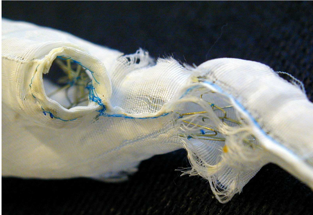
Abb. 10: Nahtruptur mit großem Defekt am rechten proximalen Schenkel (Explantat 343)
