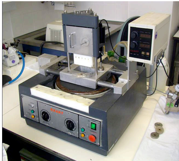
Abbildung 20. Das Tellerschleifgerät diente zur Erstellung des 300 \mu\text{m} dicken Schliifpräparats.
