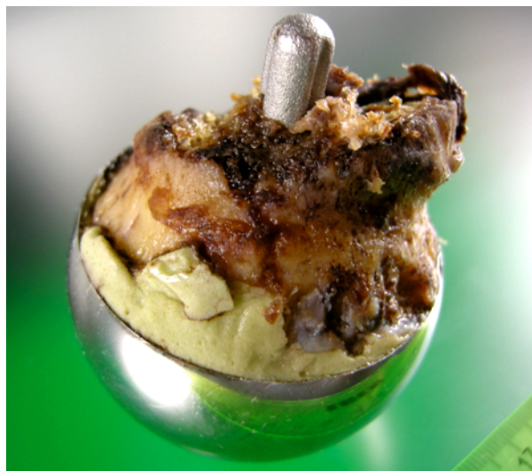
Abbildung 13. Nativpräparat einer durch Fraktur versagten Kappenendoprothese.
