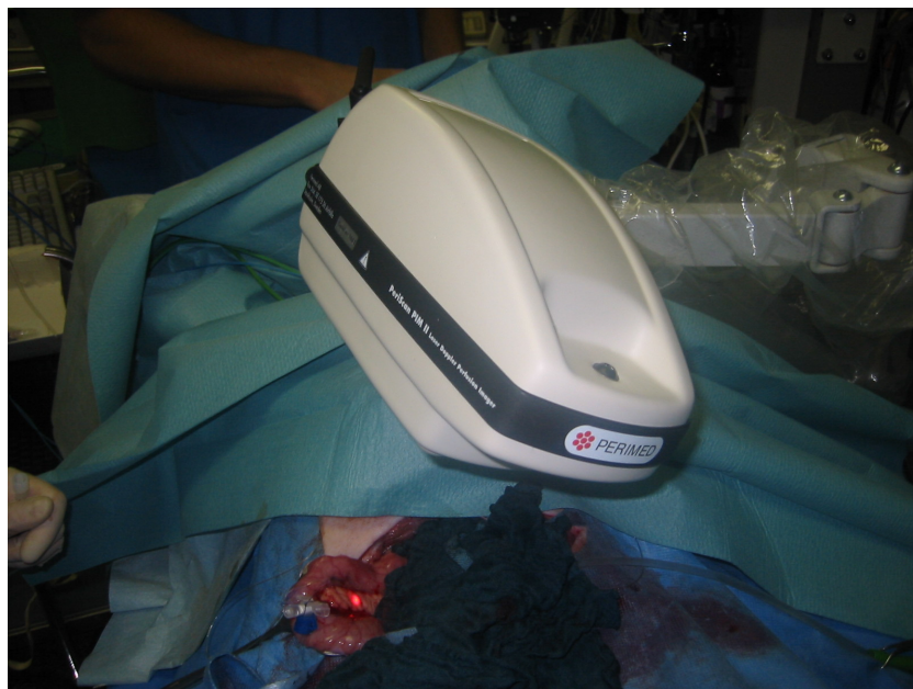
Abbildung 2.7: Messung der Mikrozirkulation des Pankreas mittels Laser-Doppler-Scanner PeriScan PIM II
