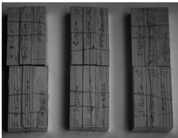
Abbildung 40: Probe aus Kiefernkernholz mit abgeklebten Kantenflächen und einer emittierenden Fläche von insgesamt 722 cm 2
