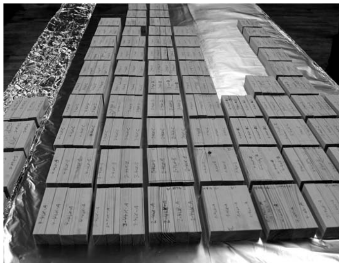
Abbildung 39: Einzelstücke aus einem Stamm zur Herstellung homogener Proben
