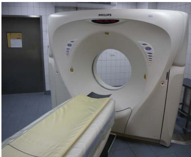
Abb. 2: 4 Zeilen–Multislice Computertomograph „MX 8000 Quad 4“, Philips; Institut für Rechtsmedizin Hamburg.
