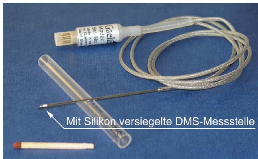
Abbildung 24: Druckmessnadel für die Bestimmung intervertebralen Drucks. Huber et al. (2005).
