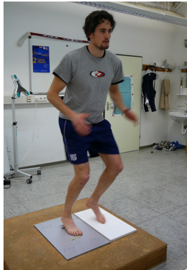
Abbildung 2.4: Proband bei der Durchführung des FTT15 auf einer Kraftmessplatte
