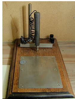
Abbildung 1.1: Whipple-Tapping-Board (1920er Jahre) für Ermüdungs-Experimente aus dem Bereich der Psychologie
