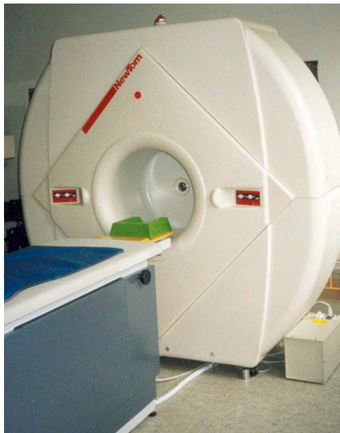
Abb. 11: Stationärer NewTom - DVT - Scanner mit Patientenliege.
