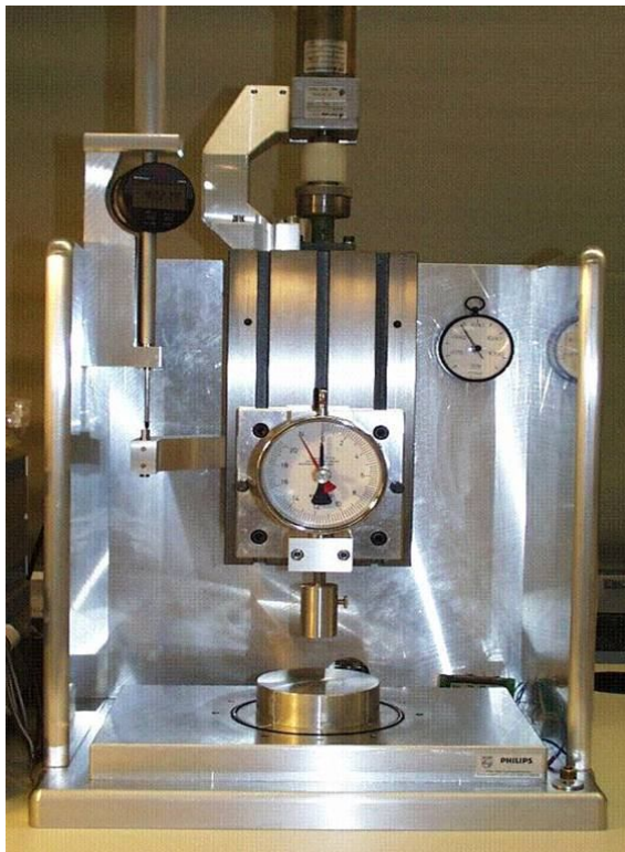
Abb.1 Messapparatur zur Bestimmung der Elastizität von exzidiertem Brustgewebe
