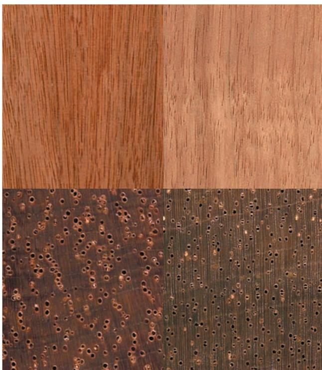
**Abb. 2: Makroskopische Holzstruktur (Längs- und Querschnitt, Vergrößerung 12 x) der Hölzer Bintangor (links) und Kasai (rechts)**
