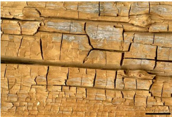
**Abb. 8: Braunfäule: Dielenbrett, abgebaut durch *Serpula lacrymans*. Auffällig ist der in der Größe variierende Würfelbruch und die Braunfärbung des Holzes, Maßstab 20 mm.**
