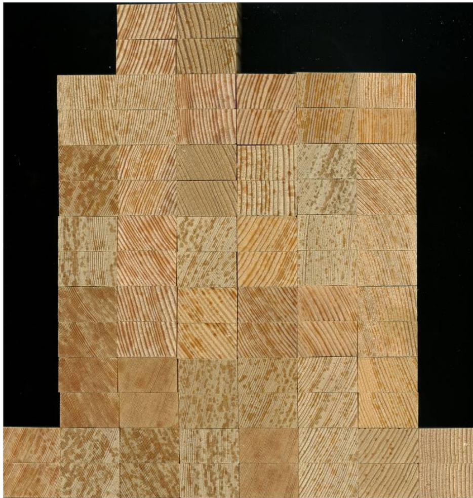
Abbildung 5: Prüfkörper (Sterilkontrollen) nach den ermittelten Dauerhaftigkeitsklassen (DHK) sortiert.
