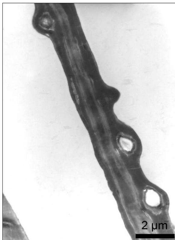
Abb. 37: Dübel (TEM-Aufnahme, *Fraxinus excelsior*): Fortgeschrittener Abbau; in den Resten der Sekundärwand befinden sich Bakterien, die S1 und die Primärwand/Mittellamelle werden nicht abgebaut bzw. erscheinen intakt.
