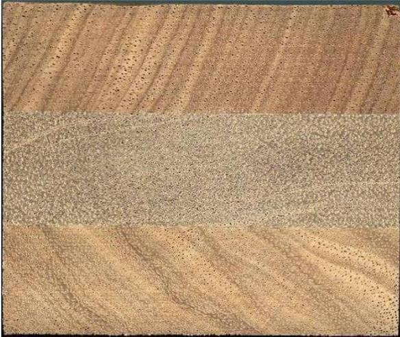
Abb. 1: Querschnitt einer Fensterkante aus drei unterschiedlichen Holzarten, sog. „mixed tropical species“: Von oben nach unten: *Heritiera* spp., *Shorea* spp., *Terminalia* spp.
