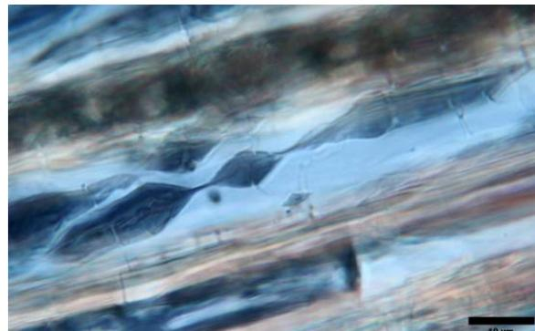
**Abb. 13: Moderfäulekavernen (Typ 1) im polarisierten Licht. Die spitz zulaufenden Kavernen sind perlschnurartig, dem Mikrofibrillenwinkel folgend, angeordnet.**
