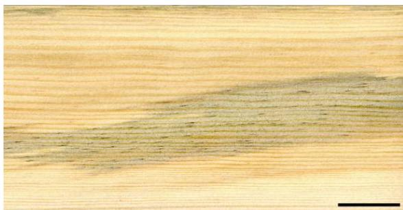
**Abb. 6: Lagerschaden: Bläue in Kombination mit Rotstreifigkeit (*Pinus sylvestris*), Maßstab 20 mm.**
