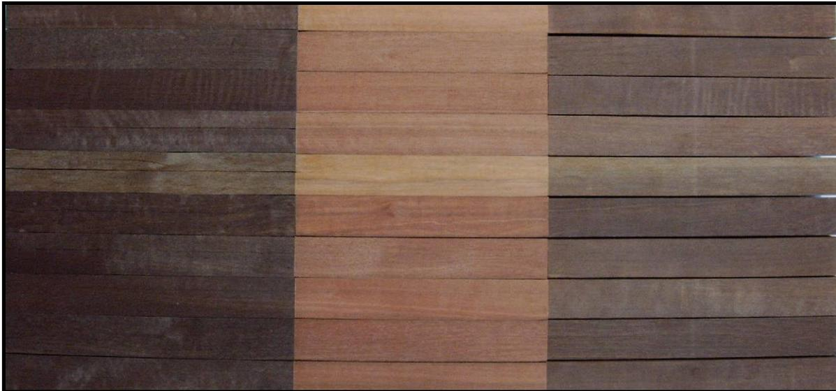
Abbildung 2: Farbverhalten der unbehandelten Holzoberflächen nach künstlicher Bewitterung und Belichtung (links) Proben nach Bewitterung, (Mitte) ohne Behandlung (Ursprungsfarbtone), (rechts) nach künstlicher UV-Belichtung.
