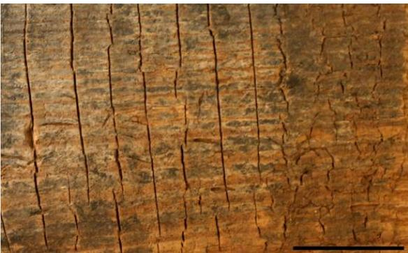
**Abb. 12: Moderfäule: Holz aus einem Kühlturm, die Oberfläche weist einen feinen Würfelbruch auf, Maßstab 20 mm.**
