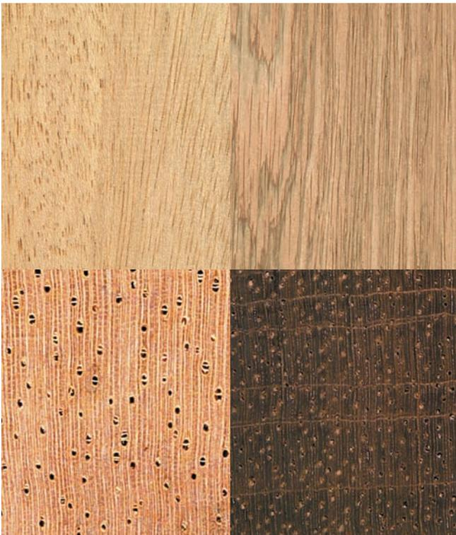
**Abb. 3: Makroskopische Holzstruktur (Längs- und Querschnitt, Vergrößerung 12 x) der Hölzer Durian (links) und Merpauh (rechts)**
