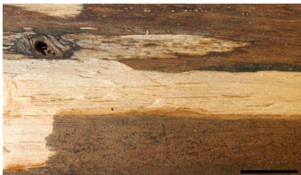
**Abb. 10:** Weißfäule: Detailansicht einer Fensterkante (*Khaya* spp.) abgebaut durch *Trametes versicolor*. Das Holz wird faserig und nimmt eine helle Farbe an, Maßstab 20 mm.
