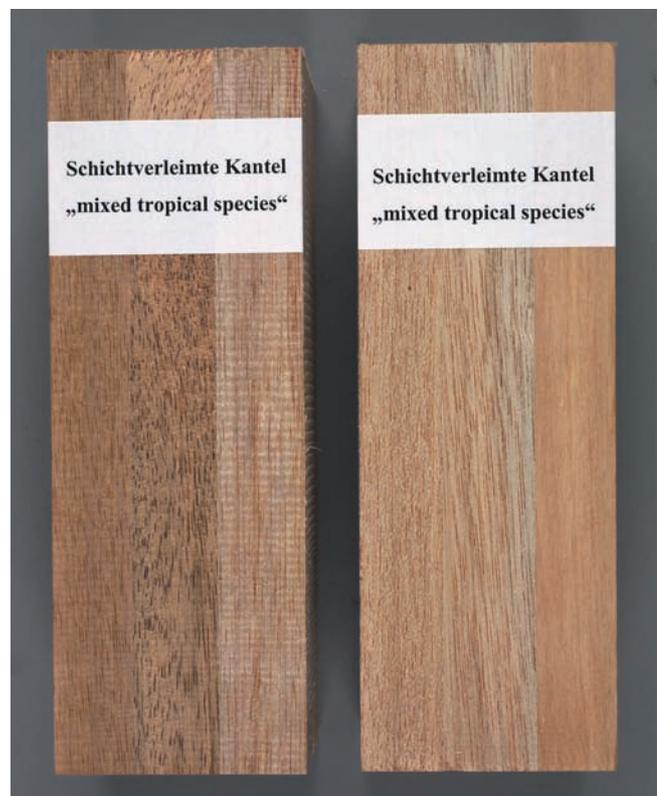
**Abb. 1: Schichtverleimte Kantelel n sog. „Mixed tropical species“, die in vielen Fällen als Dark Red Meranti (DRM) Sortiment deklariert werden**
