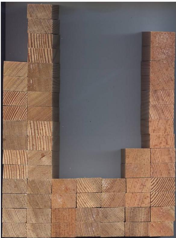
**Abbildung 4:** Visuelle Ansprache (Sortierung) der untersuchten Prüfkörper (Holzabbau durch den Braunfäulepilz *C. puteana*) nach den ermittelten Dauerhaftigkeitsklassen (DHK) und Aceton/Wasser-Extraktstoffgehalt für die Proben der Dauerhaftigkeitsklassen 1 und 4 (v. l. n. r.): DHK 4, 3, 2-3, 2, 1-3, 1-2 und 1. Der DHK 4 entspricht ein Aceton-/Wasser-Extraktionsgehalt von 1,33%, der DHK 1 ein Gehalt von 2,13% ([%] bezogen auf atro Holz)
