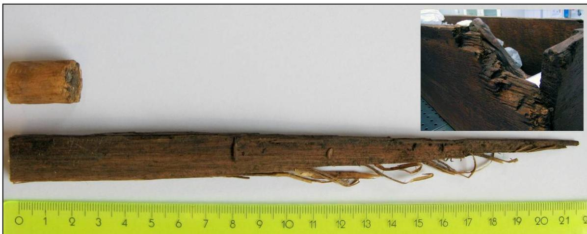
Abbildung 1: Untersuchungsmaterial (Holzdübel und Holzspan aus dem Seitenbrett „Bruchstelle/Fußende“) für die holzbiologischen Untersuchungen
