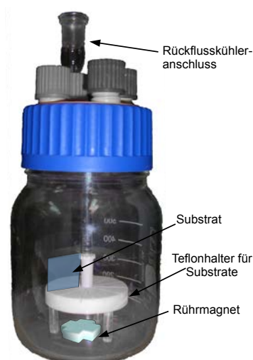
Abbildung 3.41.: Beschichtungsreaktor für ITO-CNT-Elektroden.
