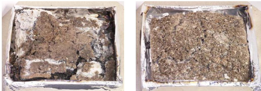
Abbildung 5.16 Brandrückstände nach der Prüfung. Die Abbildung zeigt die Rückstände einer Schaumkernplatte (links) und die einer Spanplatte (rechts) in den Probenhalternungen.
