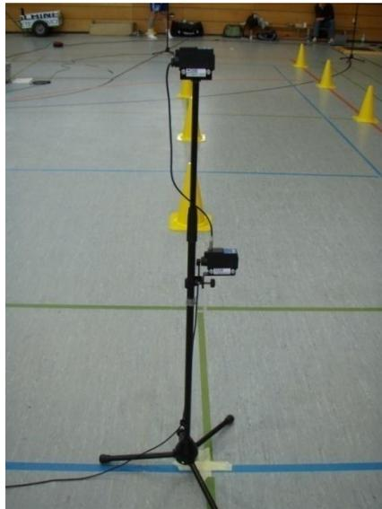
Abb. 35: Doppelte Reflexlichtschranke zur Erfassung des Slalomparcours und des Sprints.
