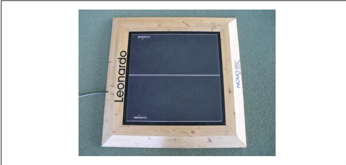
Abb. 20: Kraftmessplatte Leonardo Mechanographie.
